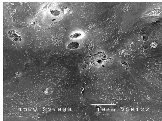
ภาพที่ 1 และ 2 ตัวอย่างภาพจากกล้อง SEM ในกรณีที่ไม่ได้รับกระแสไฟฟ้ากระแสตรง
