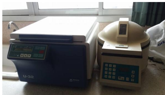
ภาพที่ 2 เครื่องปั่นที่ใช้ในการหาเลือดปนเปื้อนในห้องเรียนปฏิบัติการในรายวิชาธนาคารเลือดและภูมิคุ้มกันวิทยา
