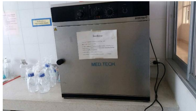
ภาพที่ 1 ตู้อบลมร้อนที่ใช้อบเครื่องแก้วและเครื่องมือที่ใช้ในห้องปฏิบัติการเทคนิคการแพทย์ มหาวิทยาลัยนครสวรรค์
